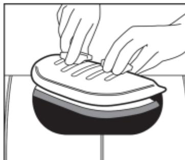
4. Installer la trappe en dévissant les boutons jusqu'à ce que dessus de l'insert le fil soit de niveau avec le haut des vis. Avec les deux mains placer la porte dans le trou de façon oblique.
