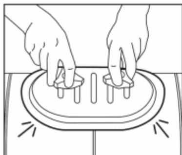
5. Ajuster la trappe d'accès dans le conduit pour l'aligner. Puis serrer les boutons.
