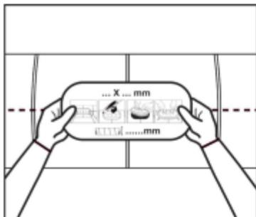
1. Coller le modèle auto-adhésif sur le conduit (un modèle est fourni avec chaque porte).
