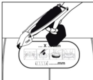
2. Utiliser un outil Turbo Shear ou similaire pour la découpe autour du modèle. Ne pas excéder la taille du modèle en découpant (la trappe d'accès fonctionnera correctement si la découpe s'ajuste au modèle, de +0 mm à 3 mm).
